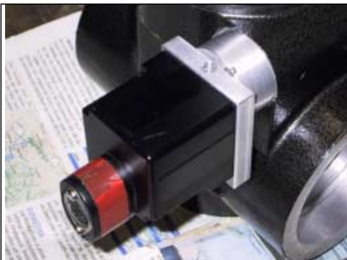
Einer der beiden Antriebsmotoren, fertig montiert
