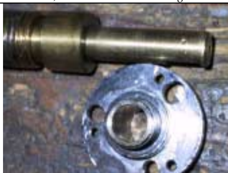
alte ausgeleierte Schneckenlager
