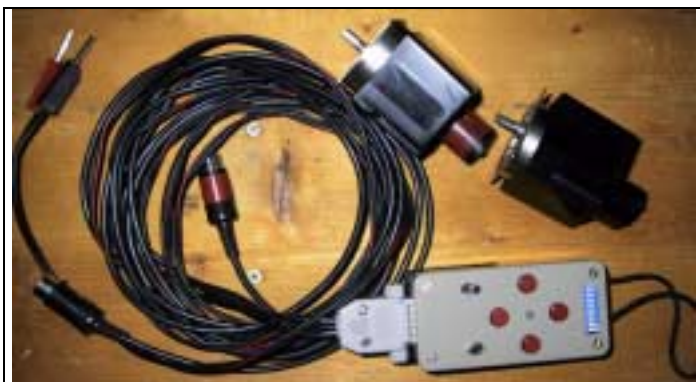
Die Steuerung MTS3 mit den Antriebsmotoren
