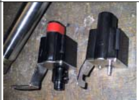
Die beiden Antriebsmotoren waren mit verbogenen Blechwinkeln weit abstehend angekuppelt
