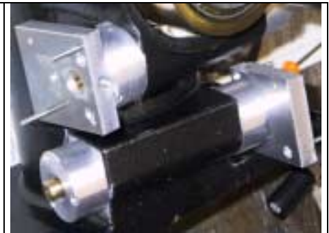
Die neue Schneckenlagerung
