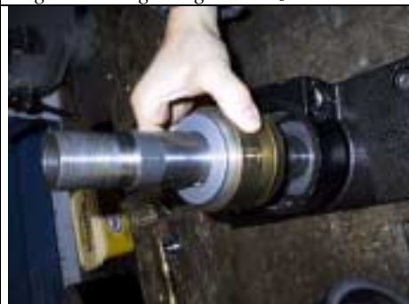
Deklinationsachse mit Schneckenrad und einfachen Gleitlagerbuchsen aus Aluminium
