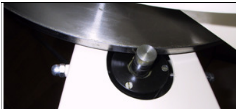
Deklinationsantrieb: Antriebswelle in einem Gabelarm
