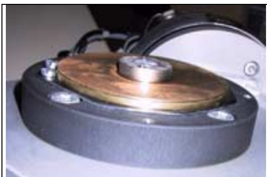
Scheibenbremse aus Federbronze
