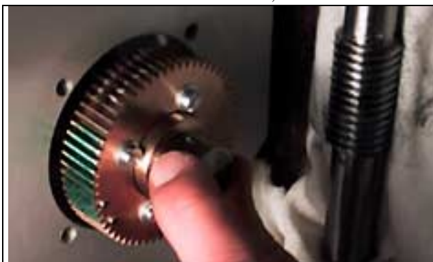
Schrägverzahntes Stirnrad und Schnecke
