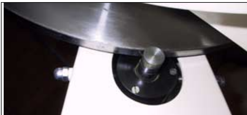
Deklinationsantrieb: Antriebswelle in einem Gabelarm
