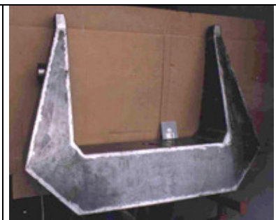
Die fertige Gabel mit den Gabelköpfen und abgeschliffenen Schweißnähten
