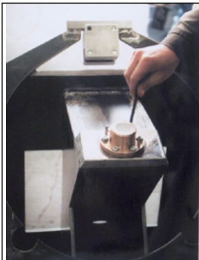
Befestigen der Lagerbuchse (Messing) mit der Teflonpfanne des Traglagers am Polblock
